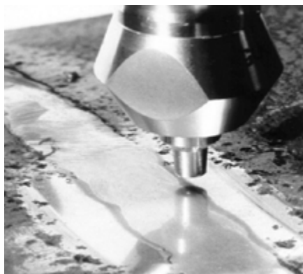
Рис. 2: Портативный метод испытания сварного шва на твердость (GE Sensing & Inspection Technologies)
