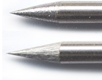
Рис. 2: Наконечники электродов для WIG сварки заточены: вверху - неправильно, т.к. заточены по окружности электрода, внизу - правильно, т.к. заточены вдоль электрода.
