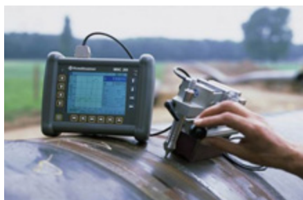
Рис. 1: Испытание на твердость на кольцевом шве (GE Sensing & Inspection Technologies)
